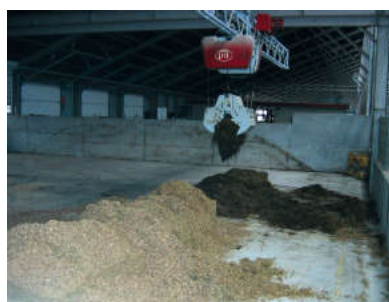
Fot. 1. Pobieranie paszy objętościowej z magazynu Fig. 1. Feed taking from warehouse
