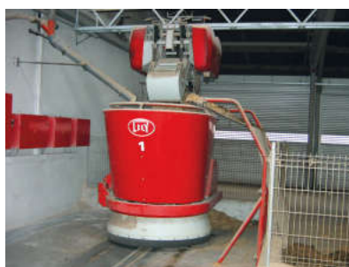
Fot. 2. Załadunek paszy do robota paszowego Fig. 2. Feed loading to the feeding robot
