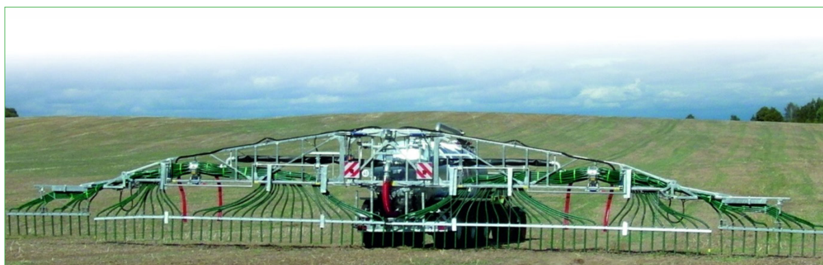
Fot. 2. Agregat z systemem węży wleczonych – Phot. 2. Aggregate with dragging hose system ( http://www.w.pomot.pl )
